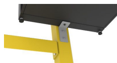
Figura 10: Tornillo M5 del soporte inferior Par de apriete: 35.4 in-lb (4 Nm)
