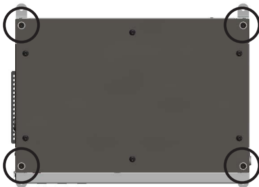
Figura 5 Puntos de fijación para las armellas de elevación M8, vista del panel superior
