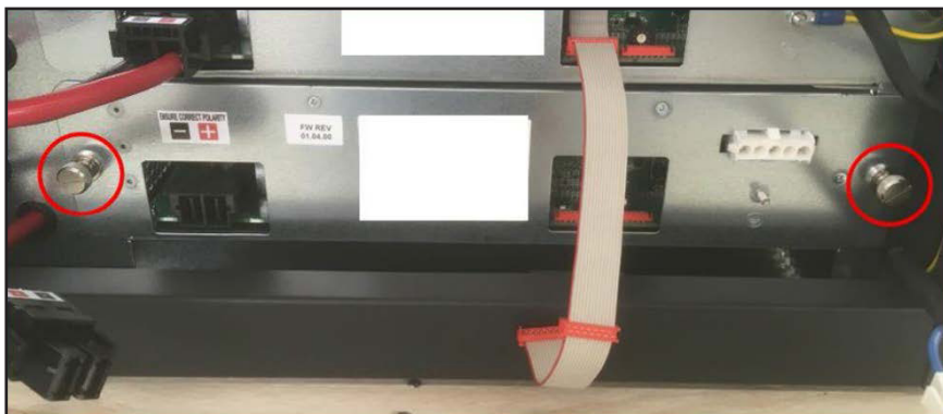
Figura 31 Inserción del módulo de energía de repuesto
