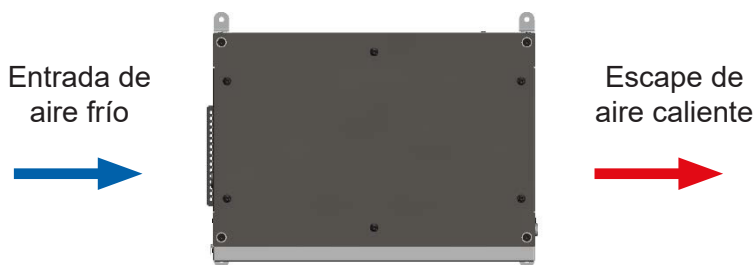
Figura 1 Diseño del flujo de aire de lado a lado, vista superior
