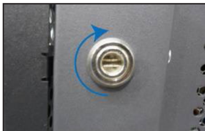
Figura 25 Pestillo en el costado del cargador
