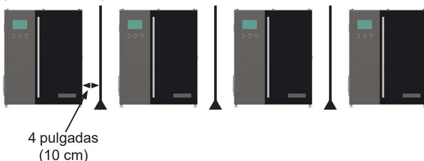
Figura 3 Espaciamiento del cargador de lado a lado con divisores
